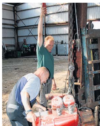
Der Motor eines Radladers muss repariert werden.
